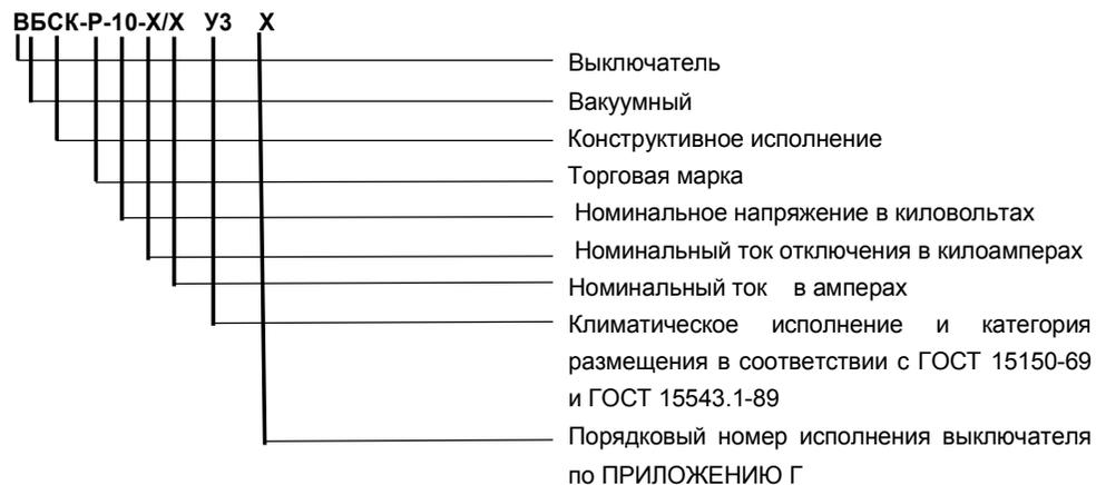
Пример записи обозначения вакуумного выключателя напряжения 10 кВ с номинальным током отключения 20 кА, номинальным током 630 А, климатического исполнения У и категории размещения 3, исполнения 017
