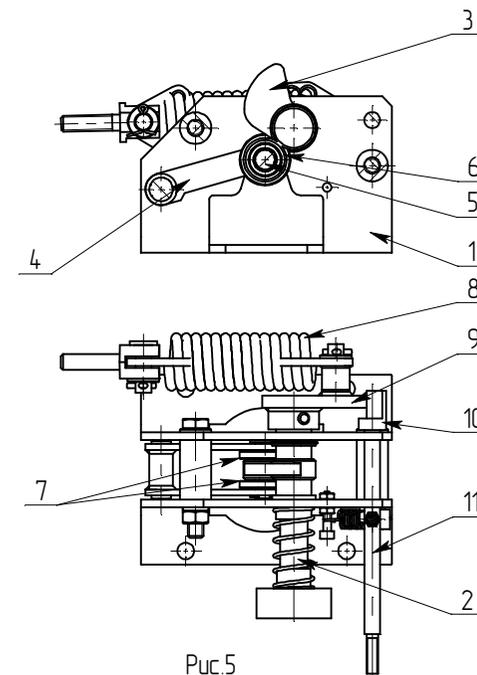
которые установлен вал 2 с кулачком 3 и рычаги 4, промежуточная ось 5 с роликами 6 и 7, пружины включения 8, кривошипа 9.
