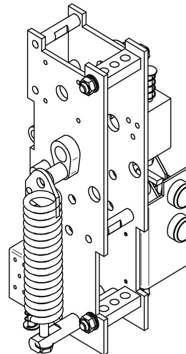
3). Блок сигнализации предназначен для обеспечения работы схемы управления выключателя. Его свободные блок-контакты предназначены для использования в схемах защиты и сигнализации положения выключателя. Блок сигнализации состоит из 8 замыкающих и 8 размыкающих контактов, связанных с валом выключателя шпилькой. Момент срабатывания блок-контактов блока сигнализации определяется регулировкой выключателя в положении «отключено».
